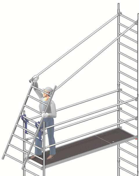
1. Agganciare l'accessorio di montaggio al telaio, posizionare il telaio successivo e agganciare i correnti
